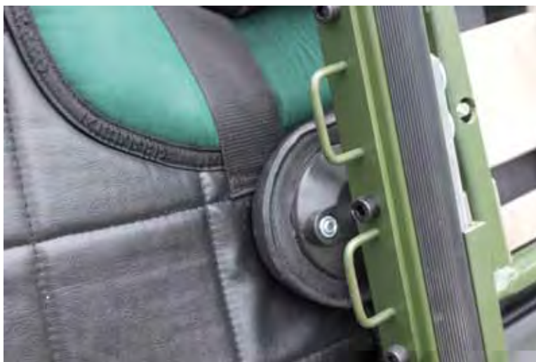
Seitliche Seitendämpfungsadaptoren – in der Höhe an den Tierkörper anpassbar
