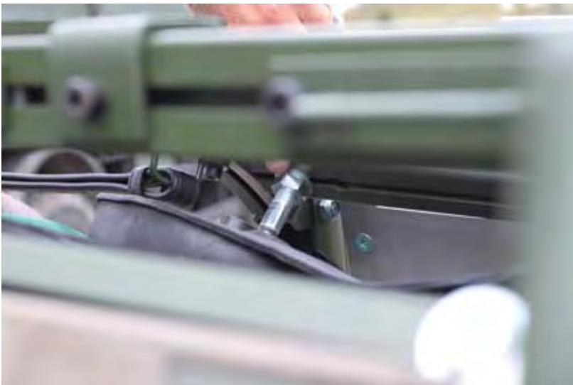
Befestigungssystem der Trachtenpads, verstellbar, zur Regulierung der Höhe zwischen Tierkörper und Packsattel
